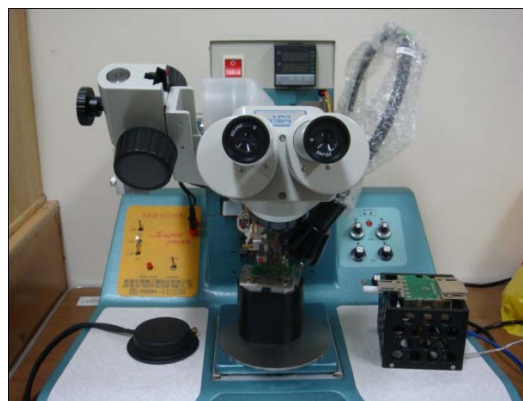
↑IC 金鋁線打線機
